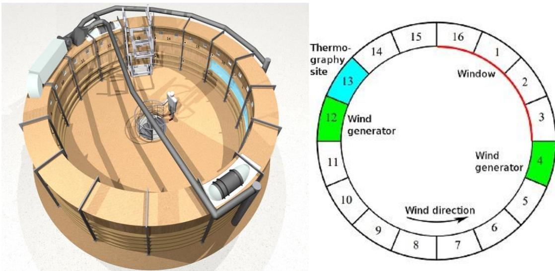
Рис. 1. Общий вид установки AEOLOTRON и схема секций с расположением вентиляторов и области измерений.
